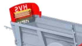
Ośłona zabezpieczająca z kratką samoczyszczącą.
